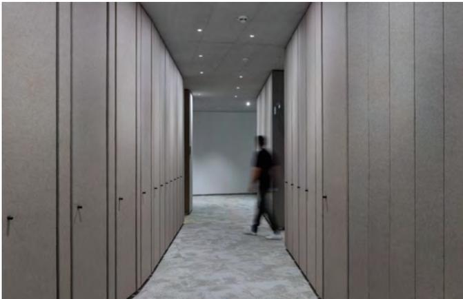
In der Fluren wird mit punktförmigen Wallwashern bewusst rhythmisches Licht erzeugt, um Monotonie zu vermeiden. Die brillante Lichtstimmung verleiht den Oberflächen (Beton, Holz und Textilien) spürbar mehr Wertigkeit und Textur.
